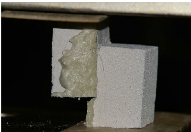
Рис. 7 Разрушение ячеистого бетона во время испытания
